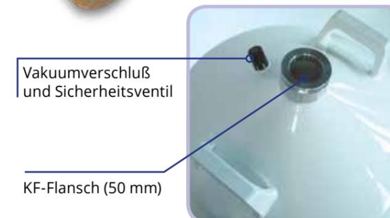
Vakuumverschluß und Sicherheitsventil
